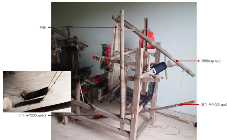
그림 23 토검직기의 문조직 제작 연동 구조
