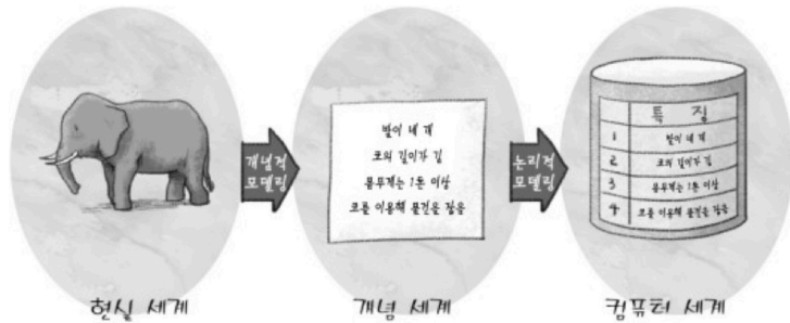
그림 12 개념적 모델링과 논리적 모델링 (출처: 김연희, 2013.6.30, 데이터베이스 개론, 네이버 지식백과)
