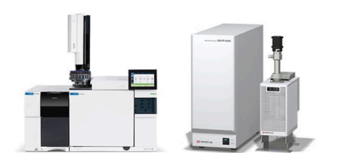
그림 26 분석에 사용된 장비(열분해-기체 크로마토그래피/질량분석기)
